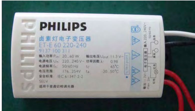
图 6：卤素射灯专用高频电子变压器
